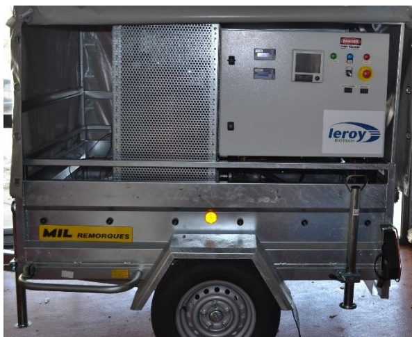
Figure 1 : générateur de Champs Electriques Pulsés
