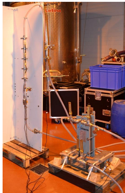
Figure 2 : Chambres de traitement du vin par Champs Electriques Pulsés (CEP)
