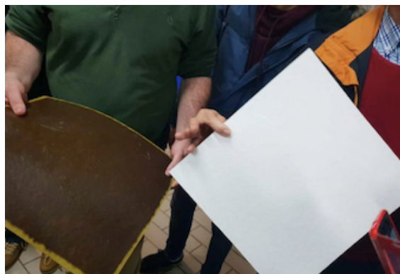
Illustration de plaques de cellulose, avant et après filtration
